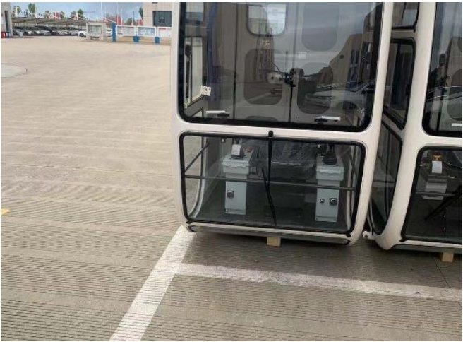
杨戈塔吊驾驶室
